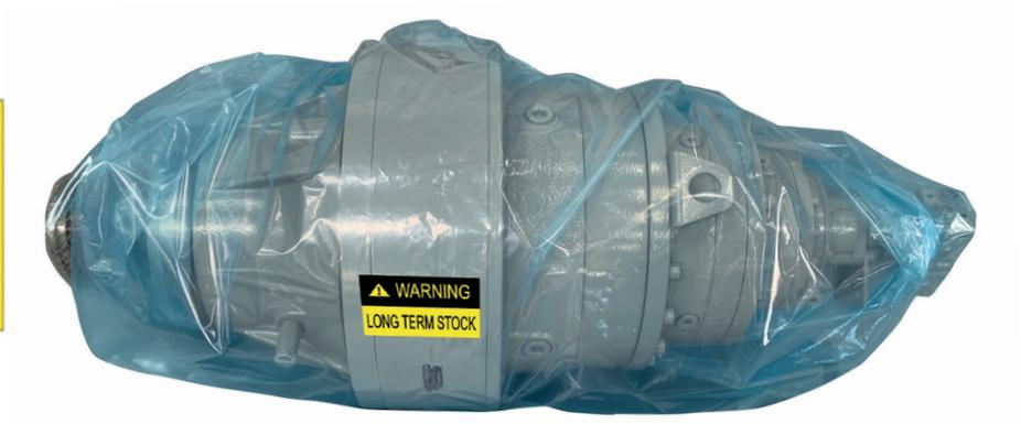
À l'intérieur du sac VpCI, une étiquette «ATTENTION STOCKAGE LONGUE DUREE», attachée à une longe, sera visible sur la surface de la boîte de vitesses:
